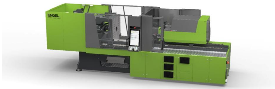
Bild 1: Mehr Werkzeugraum bei geringerer Stellfläche, die neue elektrische ENGEL victory electric 220 mit 2200 kN Schließkraft ermöglicht durch ihre holmlose Bauweise und die verkürzte Maschinenlänge eine kompakte Produktion.
