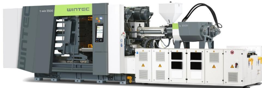
Bild 6: Die WINTEC t-win 5500 Zwei-Platten-Spritzgießmaschine mit integriertem viper 40 Roboter produziert transparente PP-Kisten mit 232 Gramm Bauteilgewicht und einer Zykluszeit von 11 bis 12 Sekunden. Die Anwendung zeigt eine ausbringungsstarke Produktion mit zuverlässiger Automatisierung und wettbewerbsfähigen Stückkosten.
