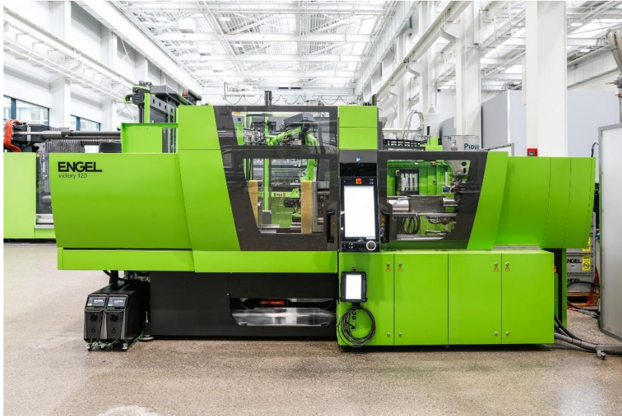
Bild 4: Spritzgießzelle mit holmloser ENGEL victory und easix Sechssachsroboter als Basis der vollautomatisierten Produktionslösung für thermoplastische Composite-Rotorblätter, Frontansicht.
