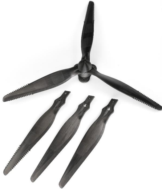
Bild 3: Rotorblätter für Drohnen aus carbonfaserverstärktem Composite, hergestellt mit der Tape-Sandwich-Spritzgießtechnologie.
