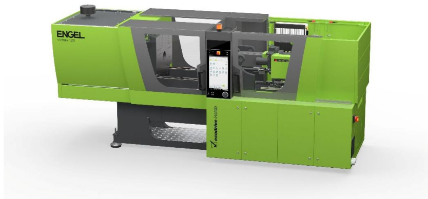
Bild 1: Die holmlose ENGEL victory 120 schafft mehr Platz für Werkzeug und Automatisierung, was kompakte Produktionszellen, geringere Investitionskosten und kürzere Rüstzeiten ermöglicht.
