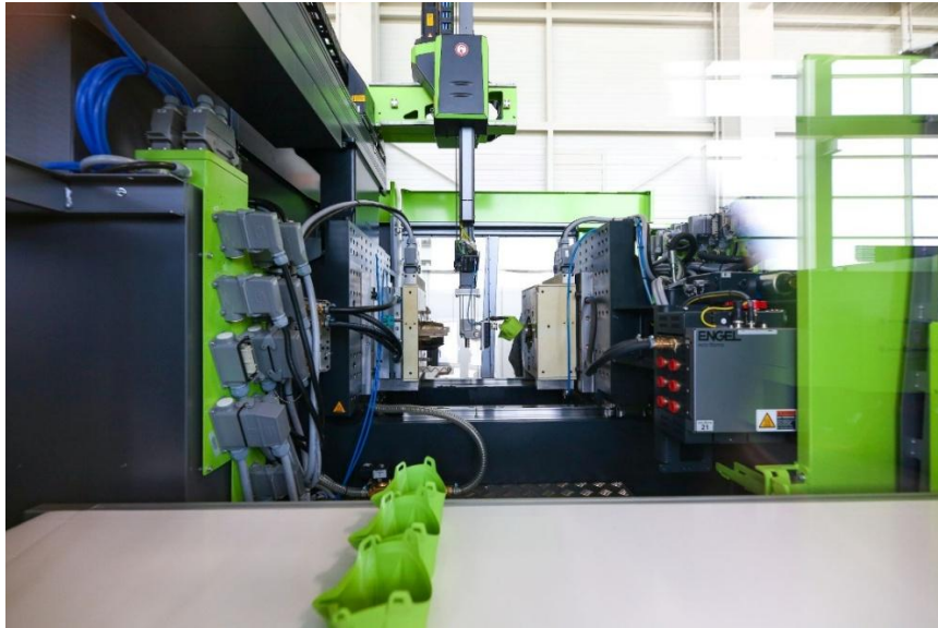
Bild 3: Die holmlose ENGEL e-victory 160 bietet mit großem freiem Werkzeugraum und großen Aufspannplatten mehr Flexibilität bei der Werkzeugauslegung. Das kann helfen, eine kleinere Maschinengröße zu wählen und Investitionskosten zu senken.
