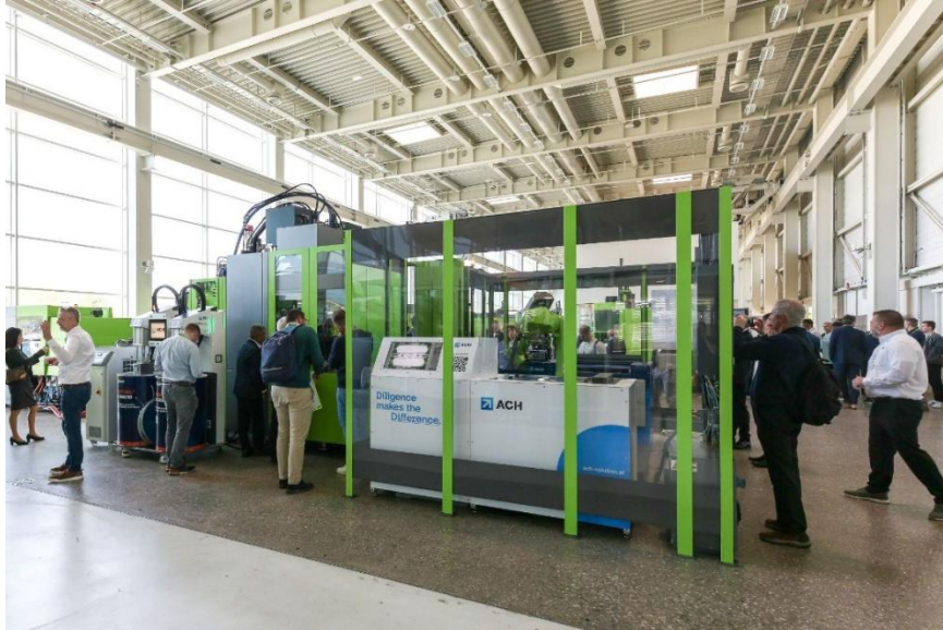
Bild 2: Die vertikale ENGEL insert 150 zeigt bei der Produktion von GDL-Folien für Brennstoffzellen, wie sich empfindliche Folienbauteile präzise, prozesssicher und mit hoher Ausbringung wirtschaftlich mit LSR umspritzen lassen.
